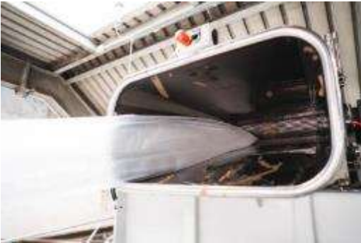
Bild 4: Oben am Trichter ist ein Rolleneinzug angebracht, der aufgewickelten Produktionsausschuss von der Rolle in den Zerkleinerungsraum zieht.
