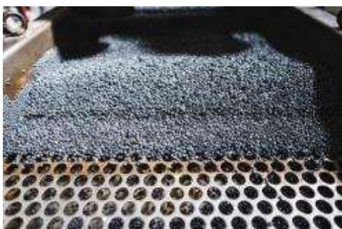
Bild 9: Mit dem Extruder wird hochwertiges Regranulat erzeugt.
